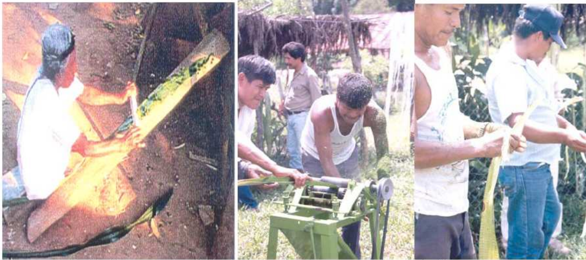
Figuras 3, 4 y 5.- Raspado tradicional de la planta y separación de la fibra usando una máquina desfibradora
